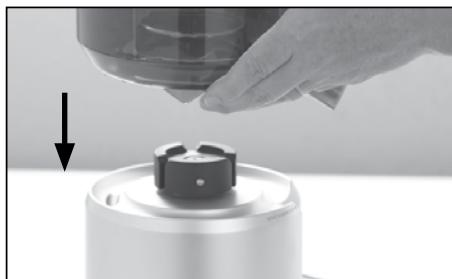
3. Alignez les flèches à la base du panier-filtre en acier inoxydable avec celles du couplage de la commande du moteur et poussez vers le bas jusqu'à ce que vous entendiez un déclic. Veillez à ce que le panier-filtre en acier inoxydable soit fermement fixé à l'intérieur du contenant du filtre et sur la base du moteur.
